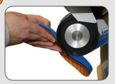
La semelle Secosol® est précisément adaptée à la chaussure et au pied à l'aide de la rectifieuse et est ensuite insérée dans la chaussure de sécurité homologuée.
